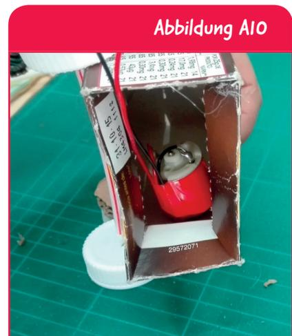
Die Unterbringung des Motors ist einer der wichtigsten Schritte dieser Aufgabe, denn davon hängt es ab, ob das Mondfahrzeug richtig funktioniert oder nicht (Abbildung A10). Um zu markieren, wo der Motor eingebaut werden soll, spannt das Gummiband um das Antriebsrad und zieht es an der Seite des Kartons entlang, bis das Band vollständig gespannt ist. Markiert diese Position auf dem Wagen mit einem 'X' und durchbohrt den Karton an dieser Stelle (Abbildung A8).
