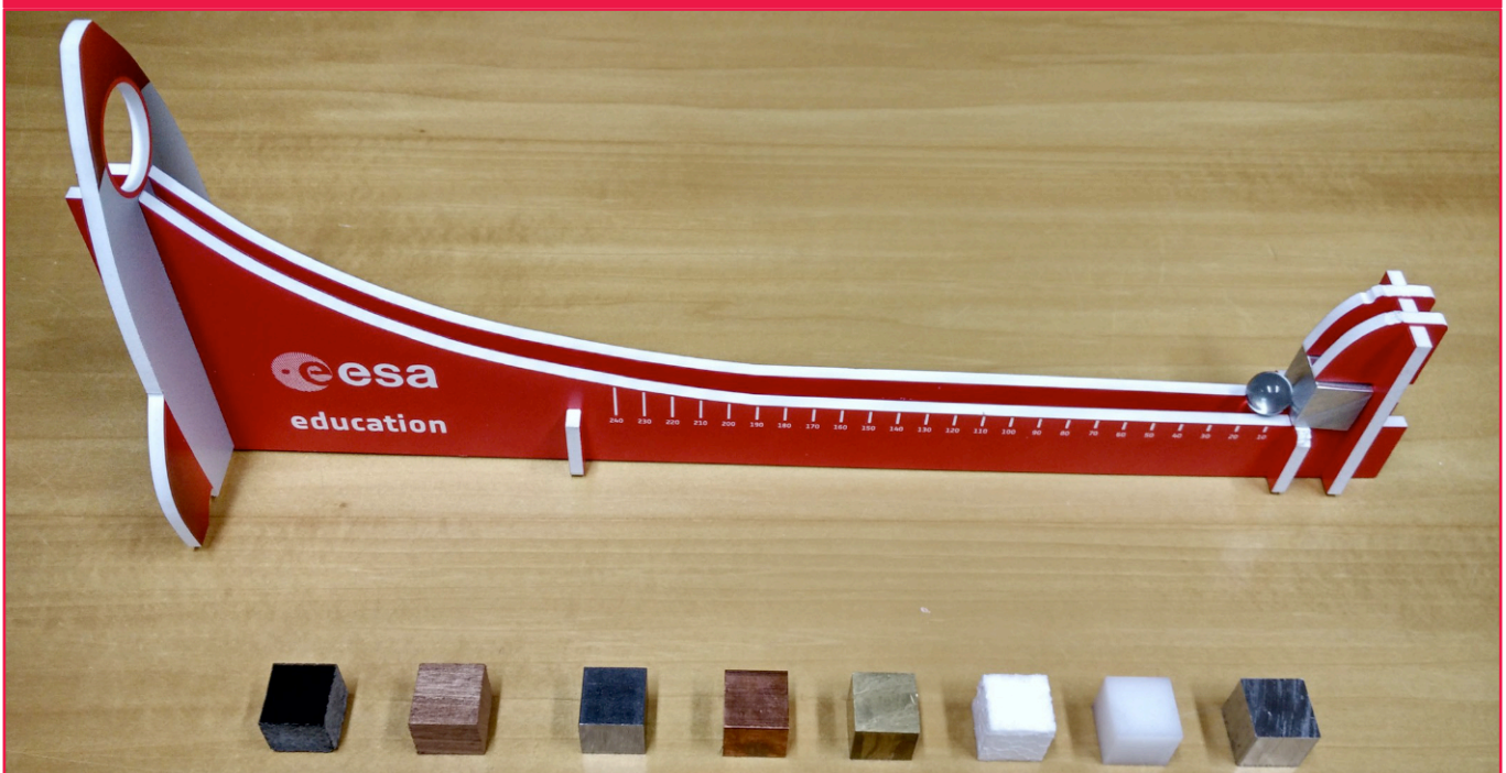
↑ Versuchsaufbau zum Ermitteln der Schlagzähigkeit
