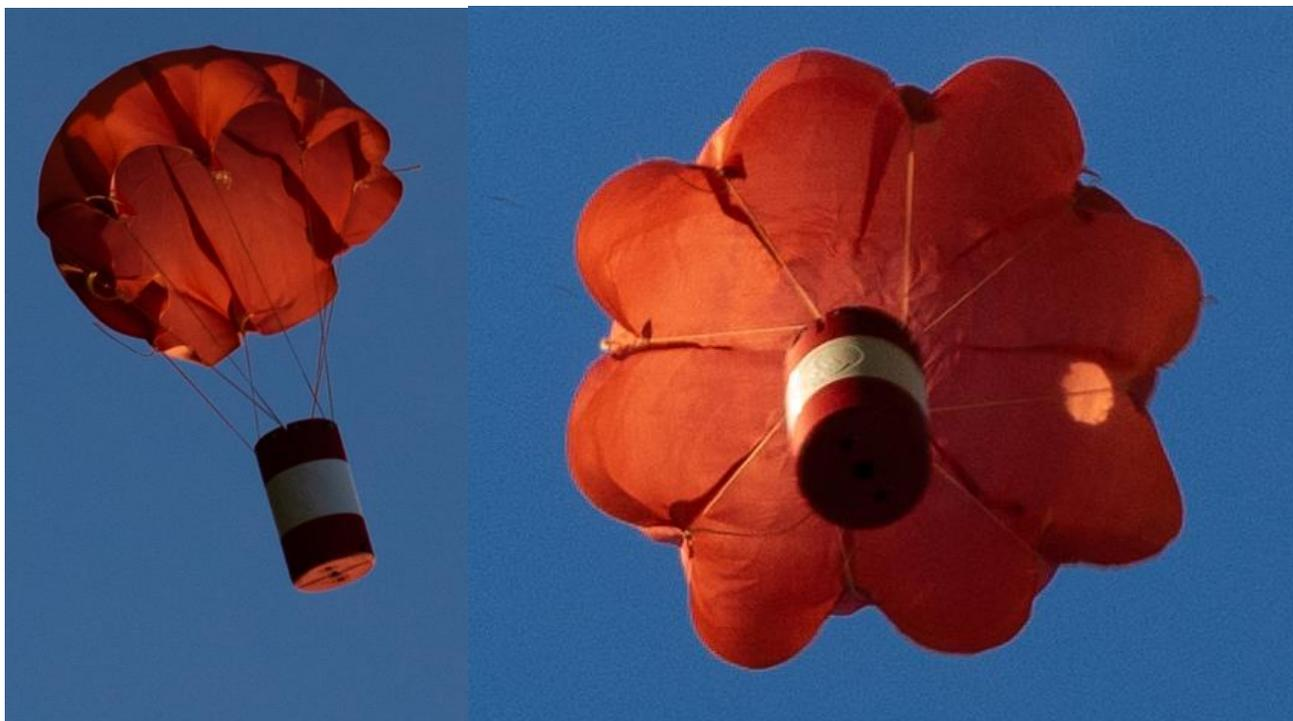
Abbildung 15: fallender CanSat mit Fallschirm
