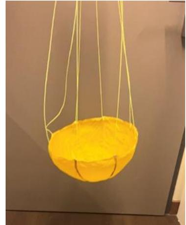
Mit der Flächeninhaltsformel von den Unterlagen der ESERO im Internet berechneten wir die Größe des Fallschirms. Zusätzlich prüften wir die Werte in einem von der Tu Wien Mathematik zur Verfügung gestellten Excelsheet. Dadurch schlossen wir auf einen Durchmesser von 32 cm.
