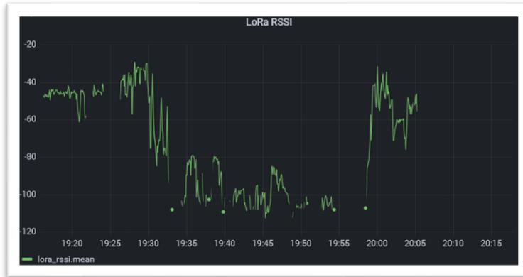
RSSI steht für *received signal strength indicator* und gibt Auskunft über die Signalstärke. Je größer der Wert ist, desto besser das Signal.
