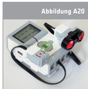
↑ A20: Ultraschallsensor, angeschlossen an den LEGO EV3-Stein
