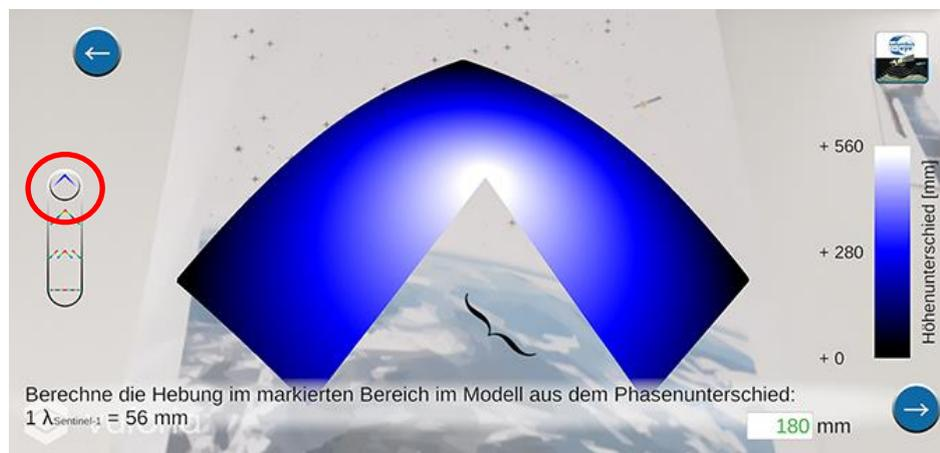
Hier soll auch vermittelt werden, dass die Technologie Unterschiede im Millimeterbereich feststellen kann – aber nur, da auch die Satellitenposition und –ausrichtung mit vergleichbarer Genauigkeit bestimmt wurde, wie in den schwierigen Matheaufgaben.
