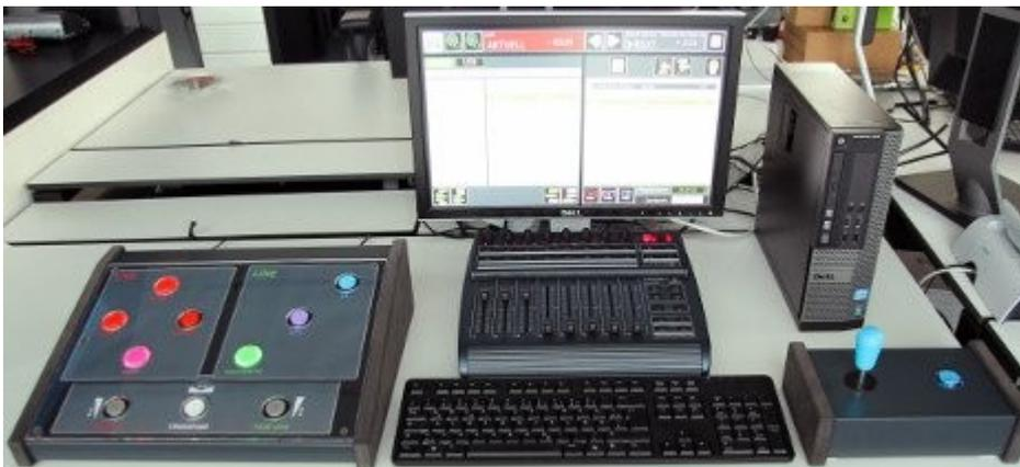
**Die Anwendung im Überblick.** openAIR besteht aus: dem Mischpult zum Ansteuern der einzelnen Kanäle, einem MIDI-Controller, einem Joystick als Mausersatz, einem Computer mit dazugehöriger Tastatur und Bildschirm und der Abspielsoftware.
